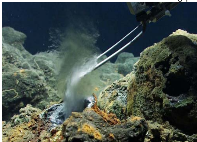
Abbildung 3: Schimmernde Ventfluide, die mit 230° C aus einem Schornstein der Kemp Caldera herausfließen und mit einem Fluidprobennehmer beprobt werden. Diese sind Eisenreich und mit einem pH-Wert von 2,3 recht sauer (© MARUM).
