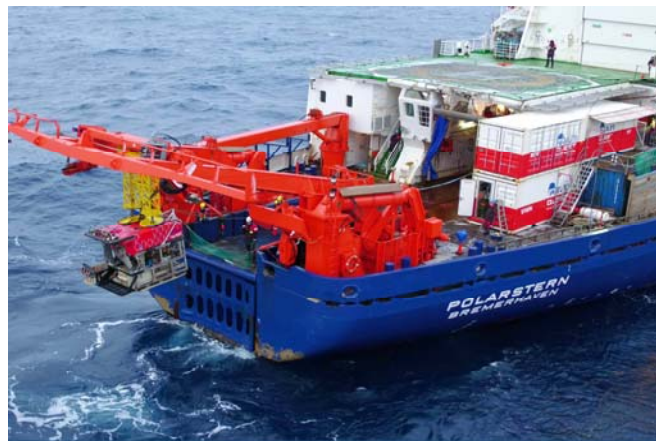
Abbildung 2: MARUM ROV QUEST wird am Heckgalgen von Polarstern zu Wasser gelassen. Der hintere Bereich des Arbeitsdecks ist von ROV-Fahrzeug, -Winde und -Container fast vollkommen belegt (© Volker Ratmeyer).
