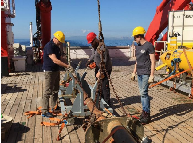
Abbildung 3: Vorbereitung der Wärmestromsonde auf dem Arbeitsdeck von FS SONNE, kurz nach der Durchfahrt der Straße von Gibraltar am Samstag (© Gerhard Bohrmann).
