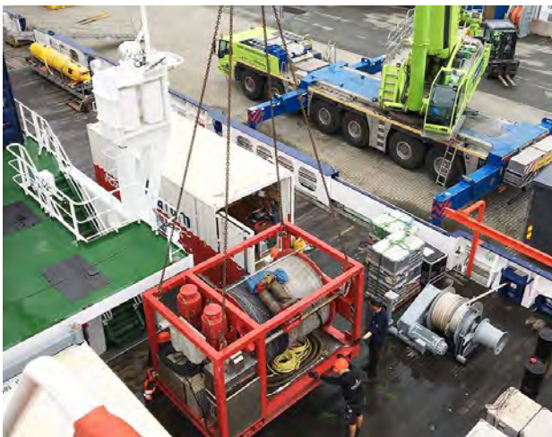
Abbildung 1: An der Pier 24 im Hafen von Breivika/Tromsø hat ein Spezialkran die 18 t-schwere ROV-Winde auf das Achterdeck von FS MARIA S. MERIAN gehievt (© Gerhard Bohrmann).
