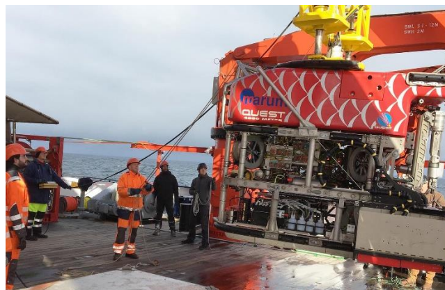
Abbildung 2: Aussetzen des MARUM ROV QUEST vom Achterdeck des FS MARIA S. MERIAN am frühen Morgen zum ersten Tauchgang der Reise bei wechselnder Wetterlage (© Gerhard Bohrmann).
