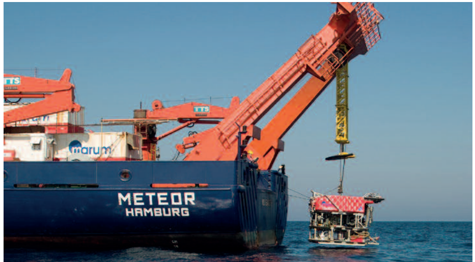
Ein ferngesteuertes Fahrzeug wird von dem Forschungsschiff Meteor aus in die Tiefsee hinabgelassen.
