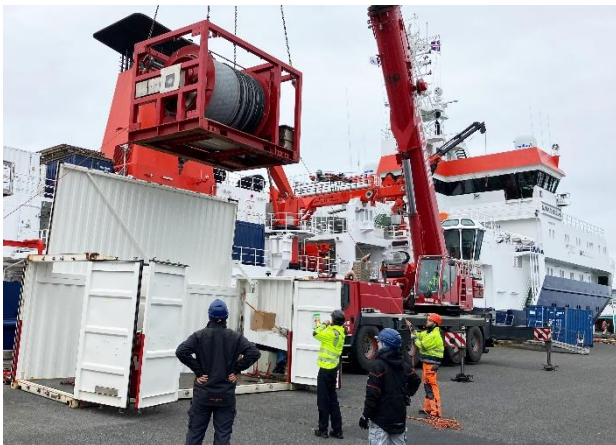
Abbildung 1: An der Pier „Grandabryggja“ im Alten Hafen von Reykjavik hievt ein Spezialkran die 18 t-schwere ROV-Winde auf die MARIA S. MERIAN (© Gerhard Bohrmann).
