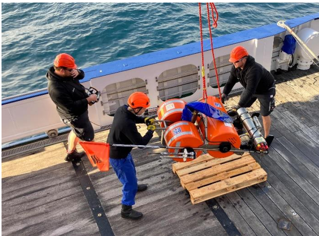
Abbildung 3: Das erste Ozeanbodenseismometer des AWI kommt an Deck, welches im Juli 2023 während FS POLARSTERN Reise PS137 im Bereich des Jøtul Hydrothermalfeld eingesetzt wurde (© Gerhard Bohrmann).
