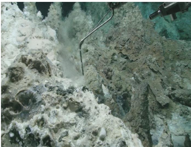
Abbildung 3: Probennahme mit einem gasdichten IGT-Sampler an einer Fluidausstrittsstelle (schimmernde Stelle) am Nidhogg Hydrothermalhügel. Die Hydrothermalgesteine sind in der Umgebung intensiv mit weißen Mikroben-Matten bedeckt (© MARUM).
