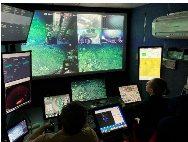
Abbildung 1: Blick in den Pilotenkontrollraum von MARUM ROV QUEST4000. Von diesem voll ausgerüsteten Steuercontainer haben die beiden PilotInnen die Kontrolle über alle Videokameras und steuern das Fahrzeug am Meeresboden (© Gerhard Bohrmann)
