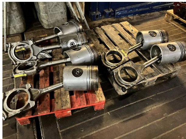
Abbildung 2: Ausgebaute Kolben des in Reparatur befindlichen Dieselgenerators, von denen insgesamt 4 Maschinen das Herzstück des Schiffes bilden (© G. Bohrmann).
