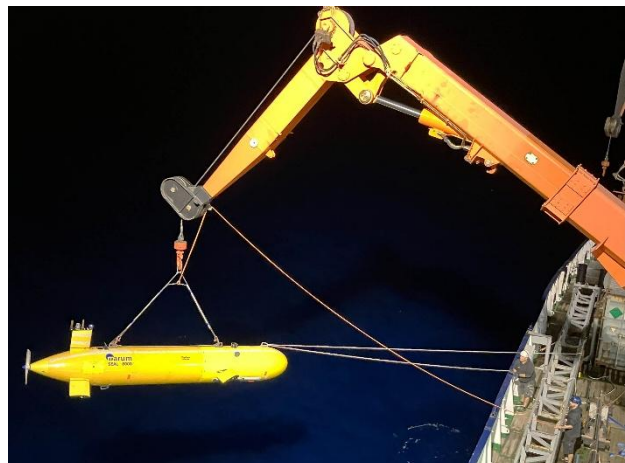
Abbildung 2: Nächtliches Ausbringen des MARUM-AUVs mit dem Schiffskran der METEOR. Bis zu zwölf Stunden bleibt das AUV im Einsatz und wird erst am kommenden Tag geborgen (© G. Bohrmann).
