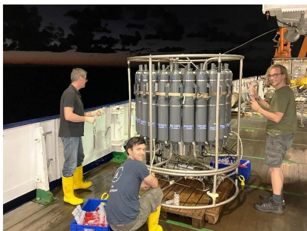
Abbildung 4: Fast täglich setzen wir die CTD des Schiffes mit den Wassers schöpfen ein. Auf unserer Expedition, wird vor allem das im Wasser gelöste Methan gemessen (© Gerhard Bohrmann).
