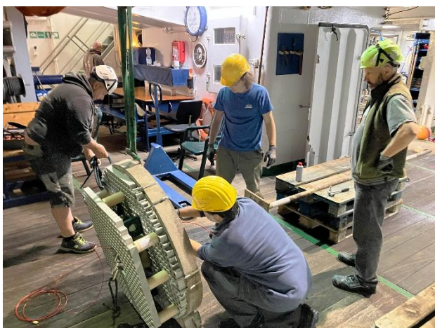
Abbildung 3: Mit Unterstützung der Mannschaft bauen die Wissenschaftler am Vorabend des Einsatzes die einzelnen Komponenten für das in-situ Piezometer zusammen (© Gerhard Bohrmann).
