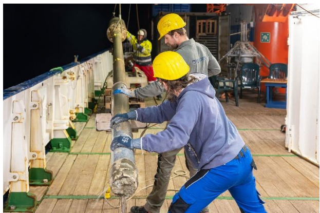
Abbildung 4: Auf der Reise haben wir 23 Sedimentkerne mit dem Schwerelot vom Meeresboden gekernt. Zur Bergung des Schwerelotes an Deck, über Tag oder in der Nacht, arbeiten die Wissenschaft und Mannschaft zusammen (© Andreas Täuber).
