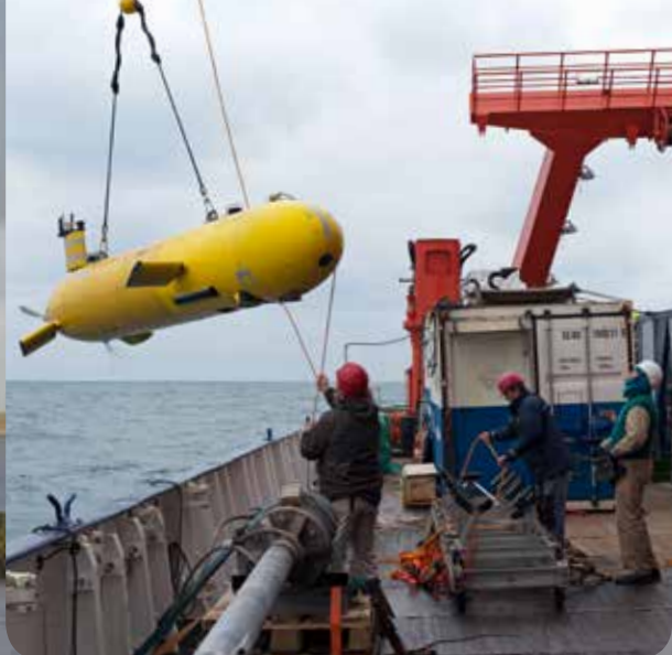
Aussetzen des Autonomen Unterwasserfahrzeugs MARUM-SEAL vom deutschen Forschungsschiff METEOR. Dieses AUV taucht bis zu 5.000 Meter tief und erstellt hochgenaue Karten des Meeresbodens.
