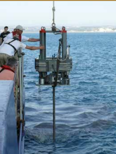
Die MARUM-Piezometerlanze wird zur Langzeitbeobachtung der Deformation von submarinen Hangsedimenten und Fluidbewegungen am Kontinentalhang vor Nizza (Frankreich) vom Forschungsschiff POSEIDON aus installiert. Hier ereignete sich 1979 eine submarine Hangrutschung, die einen Tsunami auslöste. Die Ursachen dieses Ereignisses werden von MARUM-Forscherinnen untersucht.
