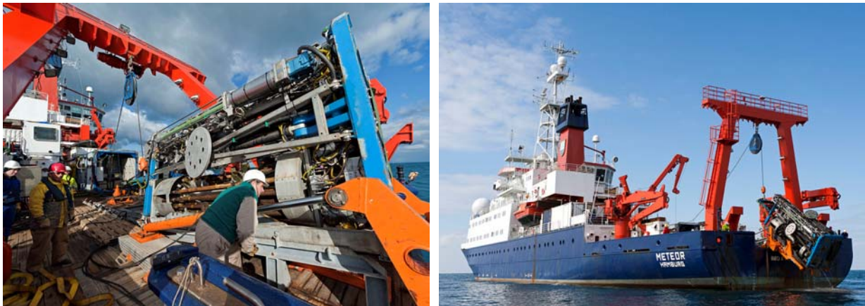
Abbildung 1: Das Meeresbodenbohrgerät vor seinem Einsatz auf dem Arbeitsdeck der FS METEOR (links); MeBo wird über das Heck ausgefahren und in die Vertikale gekippt, bevor das Gerät im Wasser zu Boden geht (rechts; Volker Diekamp, MARUM, Bremen).
