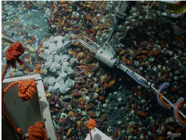
Abb.2 :Das in situ Massenspektrometer pumpt Hydrothermalwässer über eine spezielle Membran und misst dabei die Gehalte der darin gelösten Gase.
