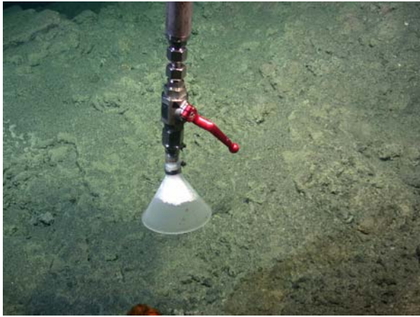
Abbildung 1: Der ROV-gestützte Gasblasenprobennehmer sammelt die vom Meeresboden aufsteigenden Gasblasen in einem nach unten offenen Trichter. Danach wird mit einem einfachen Hebel das Gas in einen Vakuumbehälter darüber eingesaugt (links). Da sich der ROV in 1100 m Wassertiefe im Gashydratstabilitätsfeld befindet, werden die Gasblasen von dünnen Gashydrathäuten umgeben, so dass sie sich im Trichter nicht miteinander vermischen (rechts). Fotos: ROV QUEST, MARUM
