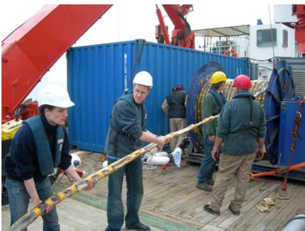
Abbildung 1: Neben der Sediment- und Gashydratbeprobung sind geophysikalische Untersuchungsmethoden während des 2. Fahrtabschnittes der M72/3 von besonderer Bedeutung. Aussetzen des 600m langen Streamers für mehrkanalseismische Messungen (links) und Sidescan Sonar DTS mit Depressor im Vordergrund kurz vor dem Aussetzen auf dem Arbeitsdeck achten.
