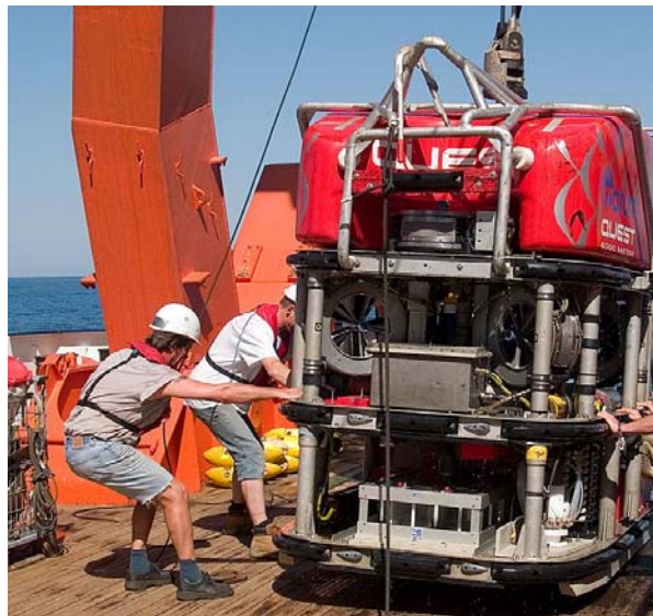
Abbildung 1: ROV-Projektleiter Volker Ratmeyer prüft mit seinen Team minutiös alle Funktionen von ROV QUEST während des sog. „Pre-dive checks“ (links), bevor der Roboter vom Arbeitsdeck der METEOR ins Wasser gesetzt wird (rechts). Photos: V. Diekamp (MARUM, Bremen).
