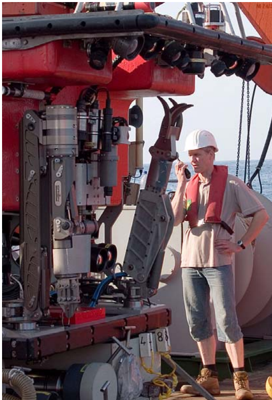
Abbildung 1: ROV-Projektleiter Volker Ratmeyer prüft mit seinen Team minutiös alle Funktionen von ROV QUEST während des sog. „Pre-dive checks“ (links), bevor der Roboter vom Arbeitsdeck der METEOR ins Wasser gesetzt wird (rechts). Photos: V. Diekamp (MARUM, Bremen).
