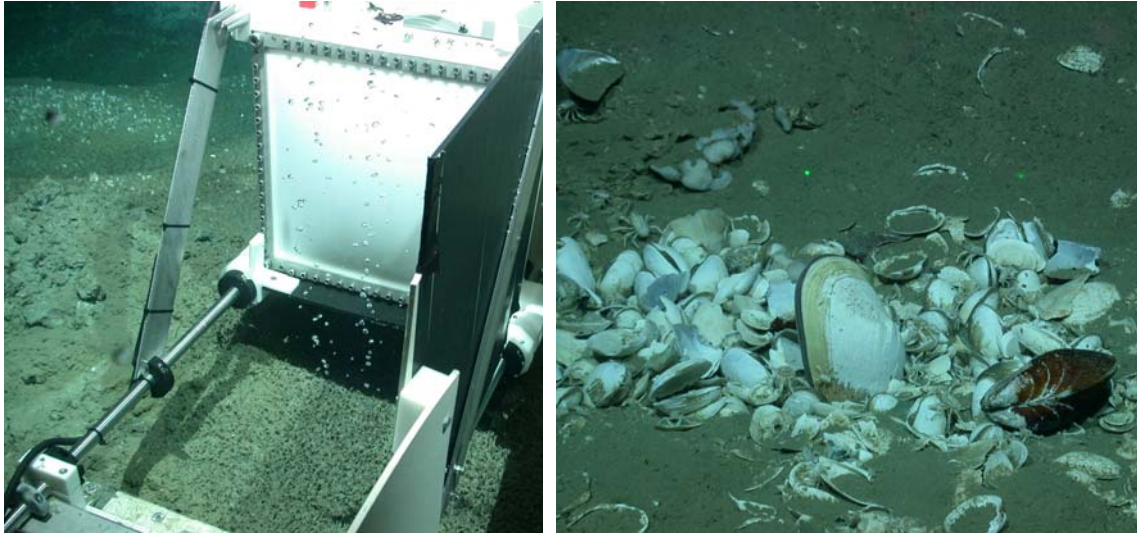
Abbildung 3 , links: Einsatz des neu entwickelten „Bubblemeters“ während ROV-Tauchgang 189, welches mit einer hochauflösenden Kamera (500 Bilder pro Sekunde) vor einem homogenen Beleuchtungsschirm (im Bild) die Blasenströme im Detail abbildet. Die Konfiguration des „Bubblemeters“ ist so gewählt, dass mit einem Computerprogramm Blasenvolumen und damit das Gesamtvolumen an Methanaustritten bestimmt werden kann. Rechts: Kleines Seep, vorwiegend mit vesicomyiden Muscheln besiedelt; im Bereich der Gasaustrittsstelle Nr. 7. ROV QUEST Fotos (MARUM).
