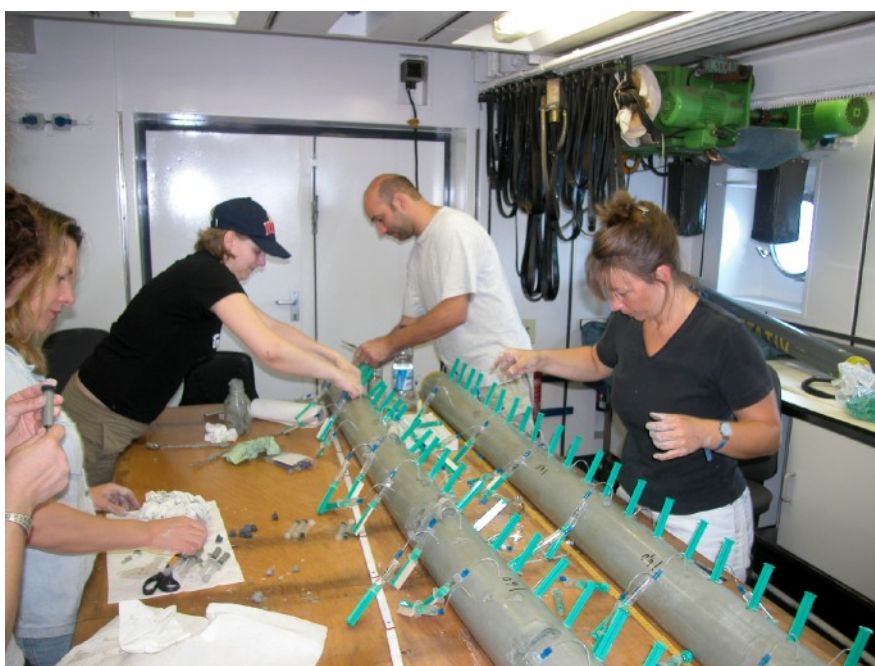
Muestreo de sedimento y agua intersticial en el laboratorio geológico del B/O Meteor
