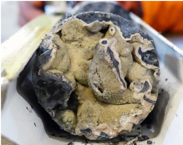
Abbildung 1: Der Rotary-Bohrer des MeBo70 hat eine in weichen Sedimenten eingeschaltete Kalkschicht durchbohrt. Helle Aragonitzemente füllen in typischer Weise die Hohlräume der Seepkarbonate.
