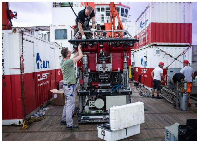
Abbildung 2: Vorbereitung am ROV QUEST auf dem Arbeitsdeck für den kommenden Tauchgang.
