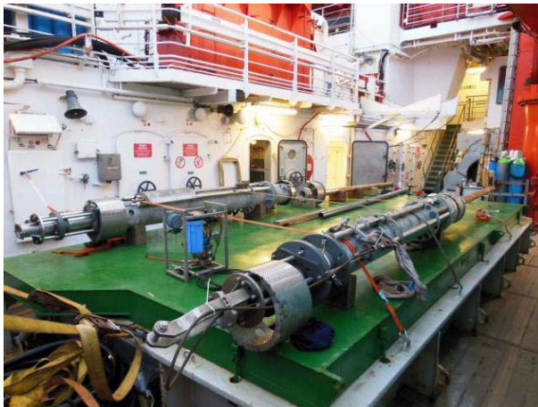
Abbildung 3: Die beiden Autoklavkolbenlote warten auf der Luke der METEOR auf ihren Einsatz.
