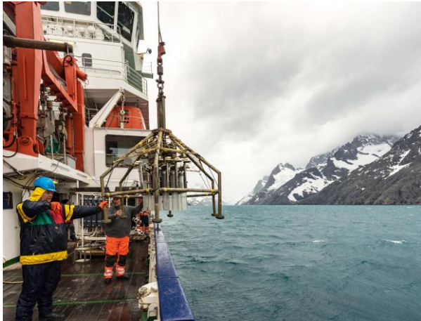
Abbildung 3: Multicorer-Probennahme im Drygalski-Fjord, der nach Erich von Drygalski, dem Expeditionsleiter der 1. deutschen Antarktisexpedition mit FS GAUSS benannt ist (© Christian Rohleder).
