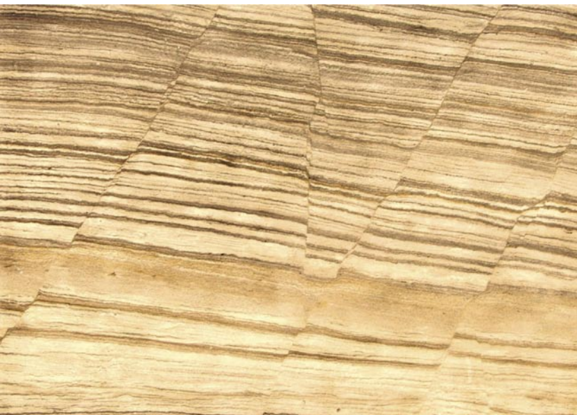
Katalog Nr. 8: Zerbrochene sandige Schichten im Wechsel mit dünneren Lagen mit viel organischer Substanz; H75, B100, DF.
