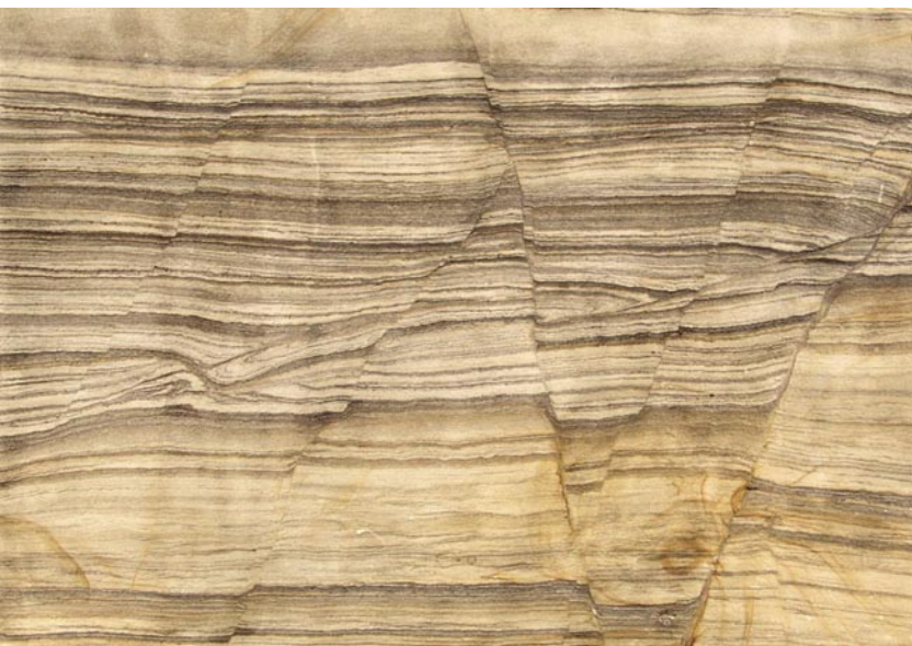
Katalog Nr. 7: Zerbrochene sandige Schichten im Wechsel mit dünneren Lagen mit viel organischer Substanz; H75, B150, DF.
