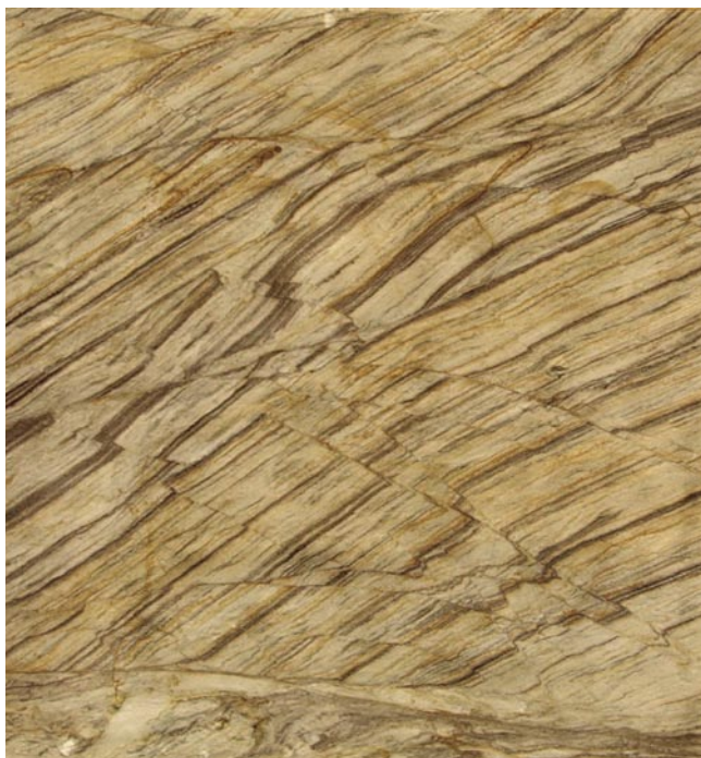
Katalog Nr. 6: Zerbrochene sandige Schichten im Wechsel mit dünneren Lagen mit viel organischer Substanz; H75, B70, DF.
